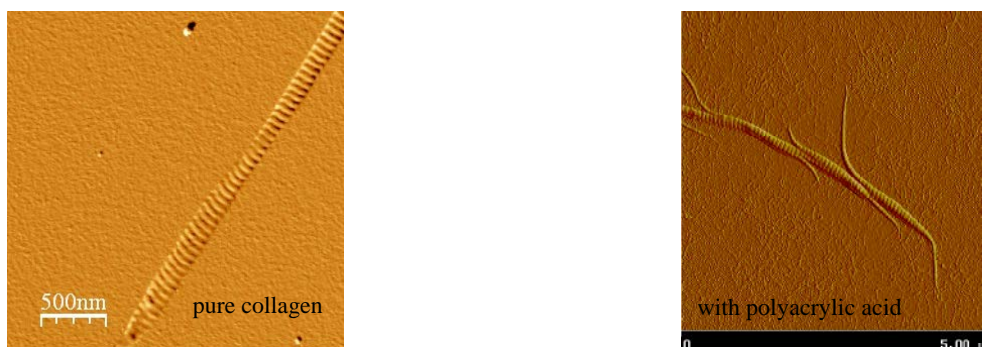
Figura 4. Imágenes AFM de las fibrillas de colágeno ensambladas sin (izquierda) y con 1 \mu\text{mol} de ácido poliacrílico (derecha).
