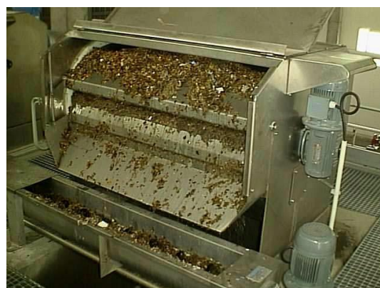
Sistemas de filtración de pelo y posterior envío al bombo del baño filtrado.
