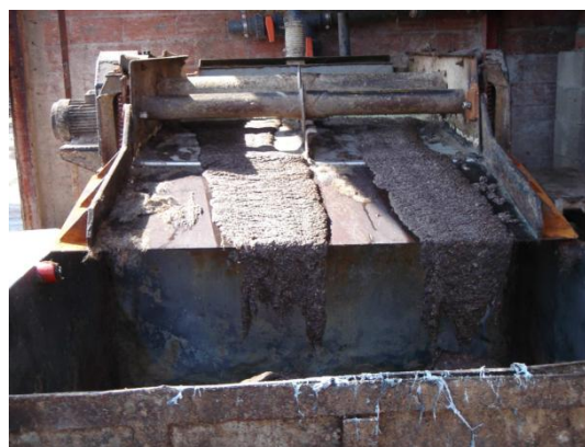
Sistemas de filtración de pelo y posterior envío al bombo del baño filtrado.
