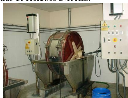
Figura 1. Bombo de curtición empleado en los ensayos de rendido con residuos avícolas
