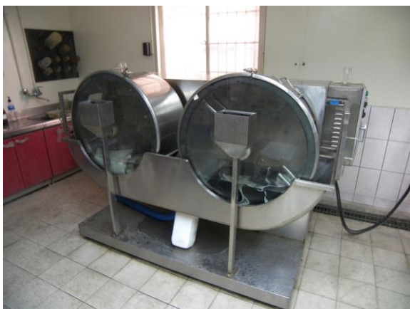
Fig.2. Aspecto del bombo de planta experimental utilizado en el presente estudio
