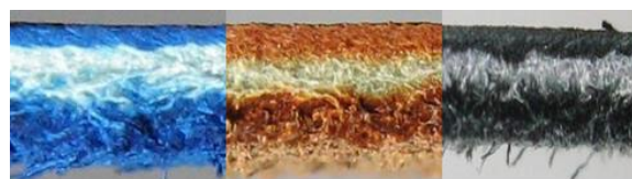
Fig.nº 11.Relación entre anionicidad y penetración de los colorantes (Sintán nº.8)
