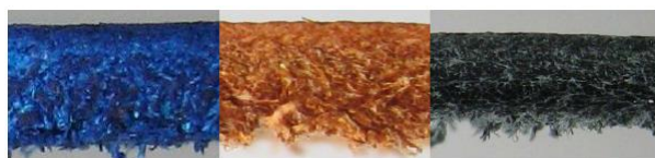
Fig.nº 9.Relación entre anionicidad y penetración de los colorantes. (Sintán nº.11)
