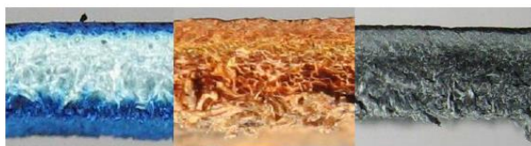
Fig.nº 10.Relación entre anionicidad y penetración de los colorantes. (Sintán n. 9)
