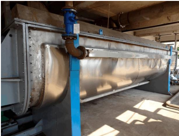
Fotografía 3: Secador de fangos de bajo coste fabricado en China
