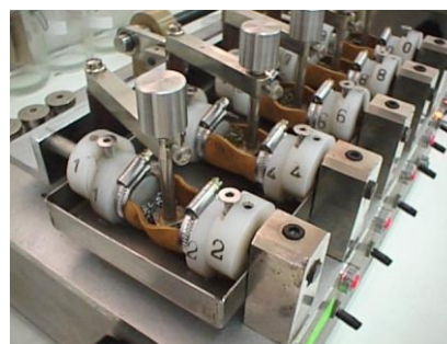
Figura 2. Ensayo de resistencia al agua para materiales de corte en calzado
