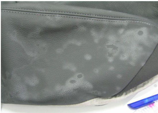
Figura 6. Eflorescencias debido a crecimiento masivo de colonias
