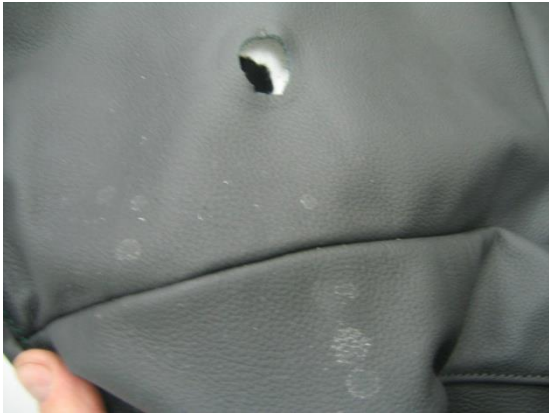
Figura 5. Eflorescencias debido a crecimiento de colonias individuales
