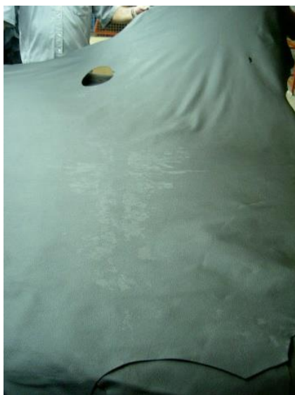
Figura 2 Patrón de eflorescencias casi especular
