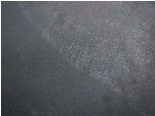
Figura 4. Eflorescencia mostrando el diseño de la malla superior de una placa de secadero al vacío
