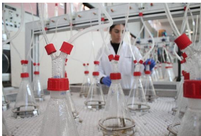
Figura 1. Equipo de biodegradación en INESCOP
